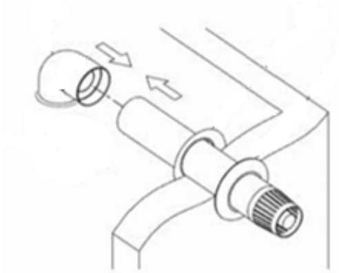
Şekil 2.11. Eş Merkezli Yatay Baca Seti İç ve Dış Duvar Contalarının montaj konumları.
